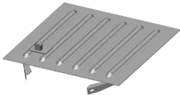
Рис. 2. Просторова модель кришки люка з фітинговим упором
