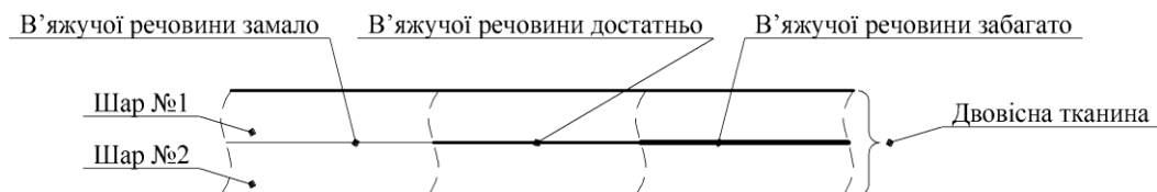
Рис. 4. Багатовісна тканина з різною кількістю в'язучої речовини
