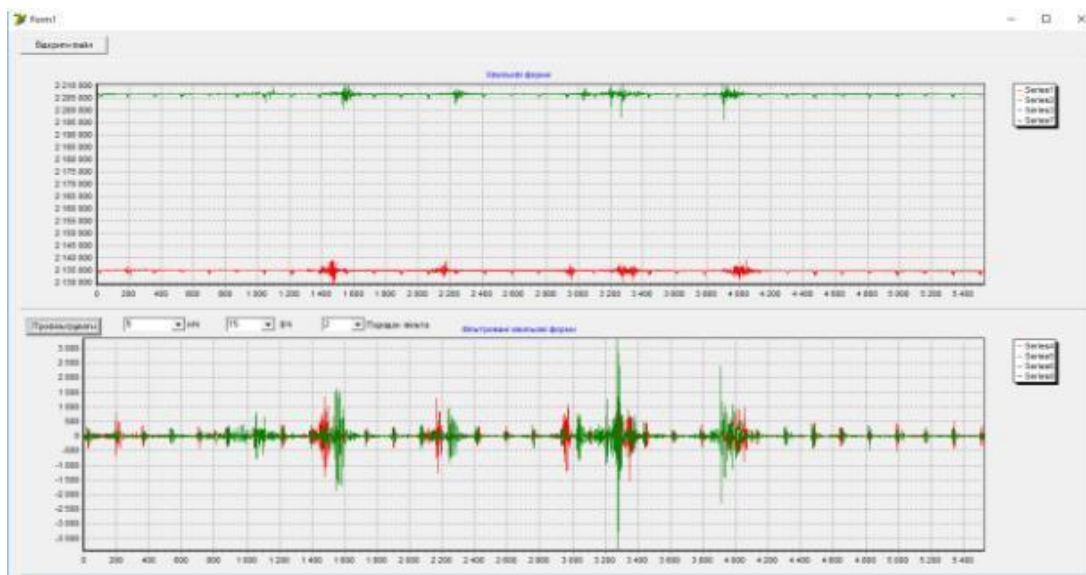
Рис. 3. Запис хвильових форм з двох геофонів
