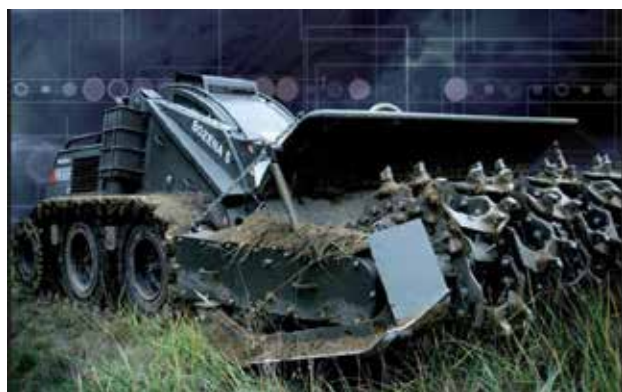
Рис. 6. Машина розмінування Bozena – 5
