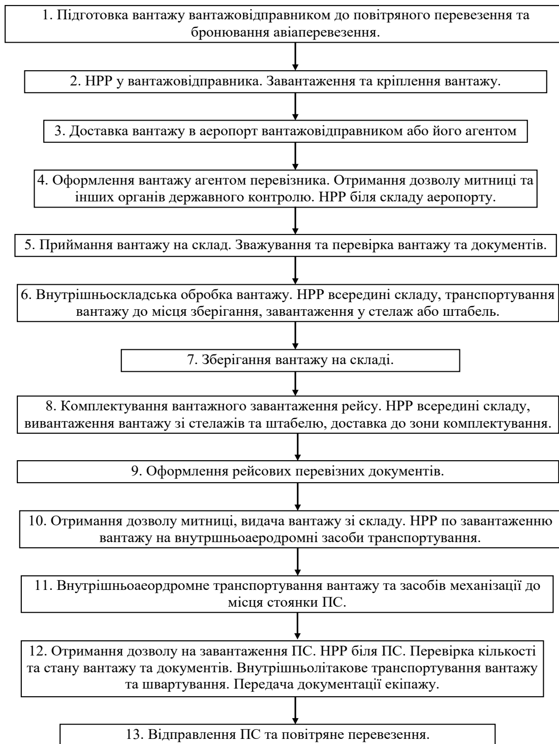
Рис. 1. Технологічна схема авіаперевезення вантажів на відправлення
